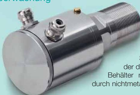
Schüttgut, das z. B. in ein Silo gefördert wird, baut sich langsam zwischen Sender und Empfänger auf und dämpft das Signal. Dies führt zu einem Schaltvorgang, der das Erreichen eines bestimmten Niveaus im Behälter meldet. Der **DYNAguard L** kann auch durch nichtmetallisches Material hindurch messen.
